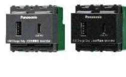
埋入式USB Power Delivery 智能快速充電插座2孔 (USB-A+USB-C) WNF1474H (灰色) WNF1474MB (霧黑) (輸入 AC 110 V / 220 V 0.5 A 60 Hz) (單孔輸出 USB Type-A DC 5 V 3 A / 9 V 2 A) (單孔輸出 USB Type-C DC 5 V 3 A / 9 V 2 A / 12 V 1.5 A) (單孔最高輸出18 W) (雙孔合計輸出15 W)
