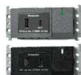
埋入式USB Power Delivery 智能快速充電插座2孔·開關組合 (USB-A+USB-C) (附螢光開關C) WTGF14746H (灰色) WTGF14746MB (霧黑) (輸入 AC 110 V 0.5 A 60 Hz) (單孔輸出 USB Type-A DC 5 V 3 A / 9 V 2 A) (單孔輸出 USB Type-C DC 5 V 3 A / 9 V 2 A / 12 V 1.5 A) (單孔最高輸出18 W) (雙孔合計輸出15 W) (螢光開關 15 A 110 V AC)
