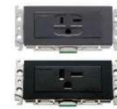
埋入式2 P 20 A附接地極插座 (附化妝蓋板) WTGF3620H (灰色) WTGF3620MB (霧黑) (20 A 250 V AC)
