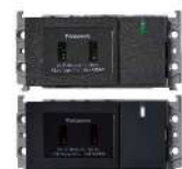
埋入式USB智能快速 充電插座2孔·開關組合 (附螢光開關C) WTGF107216H (灰色) WTGF107216MB (霧黑) (輸入 AC 110 V / 220 V 0.4 A 60 Hz) (輸出 DC 5 V 合計3 A) (單孔輸出最大DC 5 V / 2.4 A) (單孔最高輸出12 W) (雙孔合計輸出15 W) (螢光開關 15 A 110 V AC)
